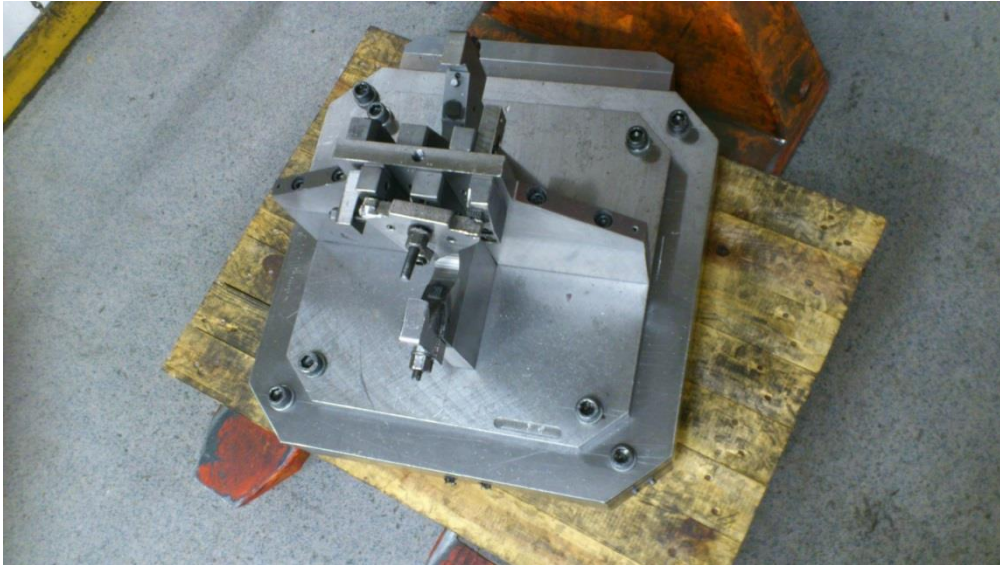
Bild 1. En fixtur fotograferad uppifrån. Denna fixtur används i fleroptionsmaskiner och kan anses vara relativt ny och modern i jämförelse med genomsnittet.
