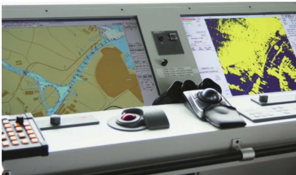
Så här ser ECDIS och radar ut på en fartygsbrygga.
