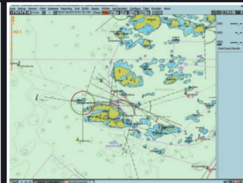
De flesta fartygen inom handelssjöfarten använder navigationssystemet Electronic Chart Display and Information System, förkortat ECDIS.
