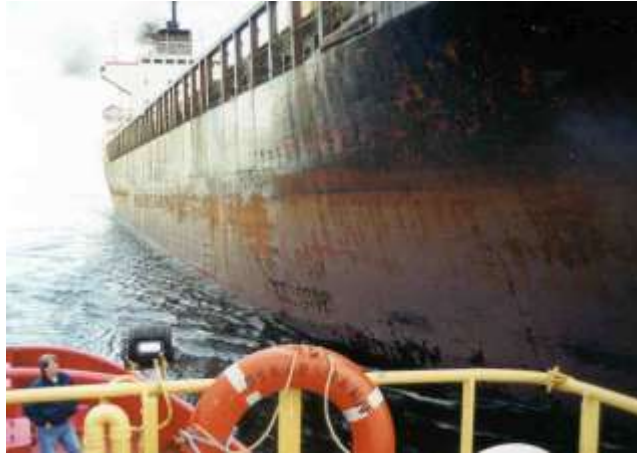
Fig. 26 Vid koppling föröver löper bogserbåten risken att hamna tvärs framför bogen på det stora fartyget.
