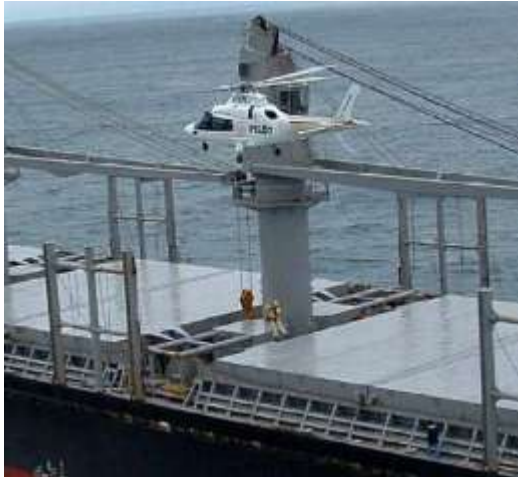
Fig. 43 Pilot transfer, ingen lämplig placering – ingen märkning
