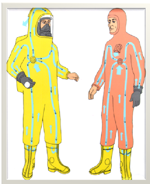
Fig. 43 Exempel på ventilerad gastät helskyddsdräkt (Trelleborg)
