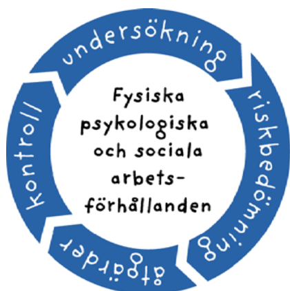
Fig. 3 Enligt de föreskrifter som Arbetsmiljöverket utfärdat i frågan (AFS 2001:1) avses med systematiskt arbetsmiljöarbete att "...undersöka, genomföra och följa upp verksamheten på ett sådant sätt att ohälsa och olycksfall i arbetet förebyggs och en tillfredsställande arbetsmiljö uppnås."
