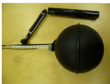
Fig. 21 Instrument för kontroll av termiska klimatet, globtermometer och slungpsykrometer.
