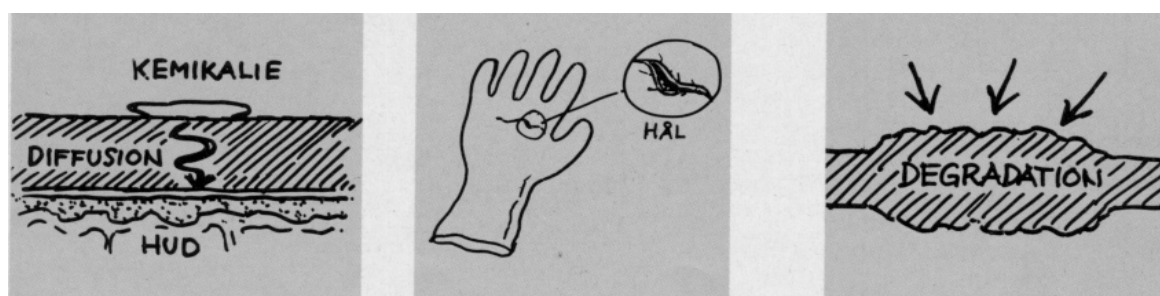
Fig. 42 Kemiska ämnen kan tränga igenom samt påverka handskmaterial på flera olika sätt.
