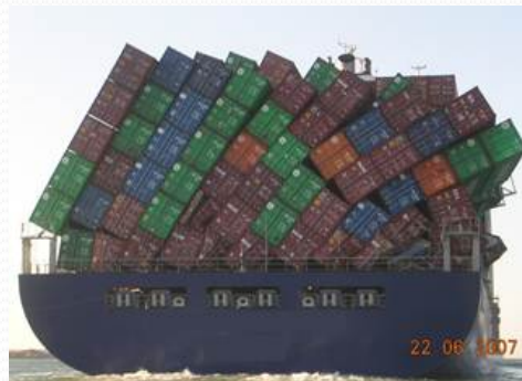
Foton på lastförskjutning på containerfartyg
